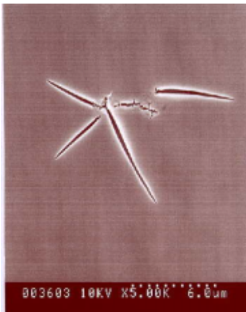
REM-Aufnahme einer Fehlstelle in einer TiO 2 Schicht
